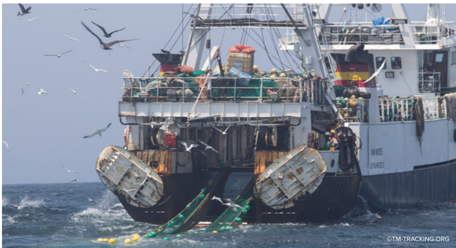
Un chalutier pélagique remontant le chalut par la rampe arrière
