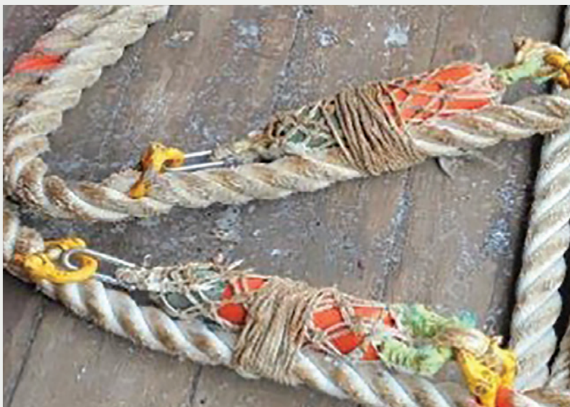
Des dispositifs de dissuasion des dauphins fixés au chalut
