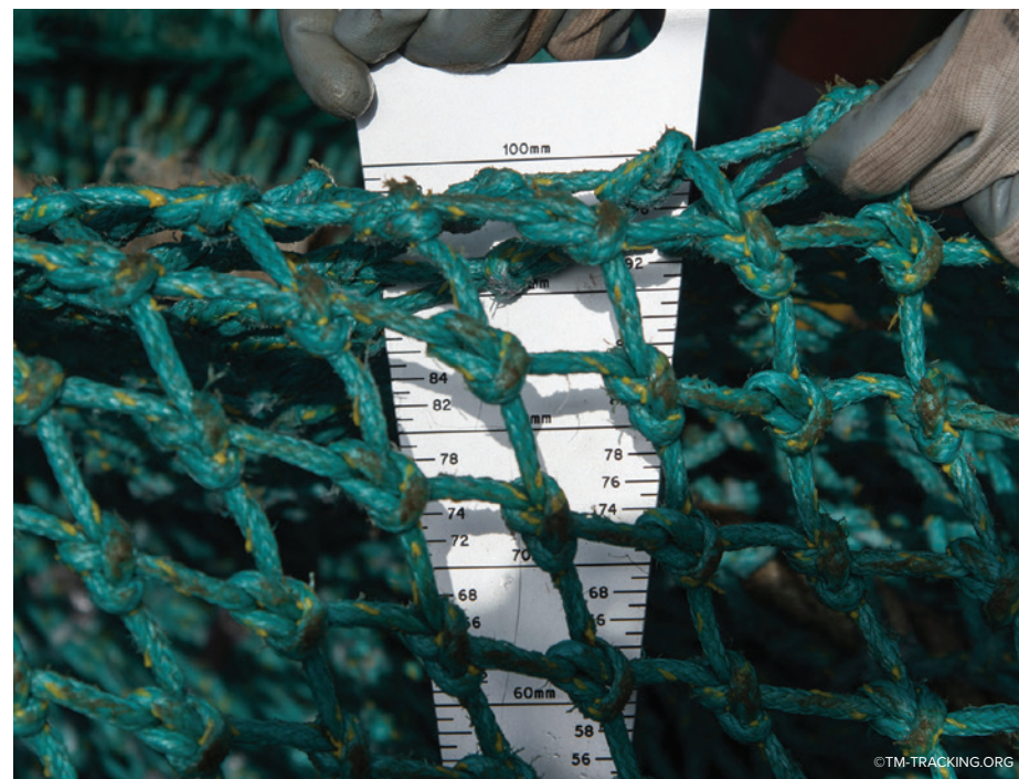
La taille du maillage peut être mesurée à l'aide d'un outil spécialisé appelé jauge plate ou jauge Oméga
